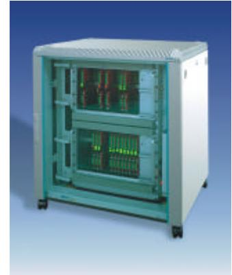
Der **PTI** ist ein hoch integriertes „plug and play“-System zur Schnittstellen-Konvertierung und Übertragung in ISDN-Umgebungen. Er ist die ideale Lösung, um die Anzahl verschiedener  $S_0$ -Schnittstellen "sternförmig" zu erhöhen.
