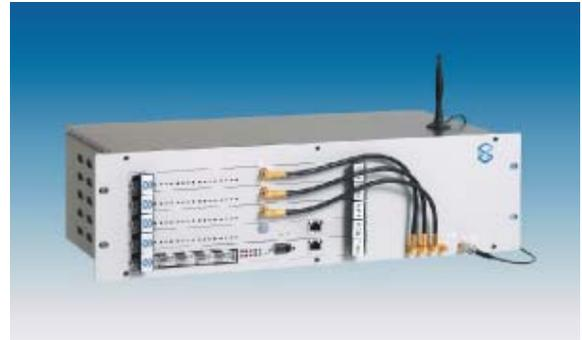
Der **NovaTec Mobilephone Gateway (NMG)** ermöglicht Ihrer Telefonanlage den direkten Zugang zum GSM-/VoIP- und ISDN-Netz. Abhängig von der gewählten Rufnummer werden abgehende Rufe automatisch über das zugehörige Netz geroutet. Der integrierte Least-Cost-Router ALCR bestimmt dabei den Verbindungsweg.
