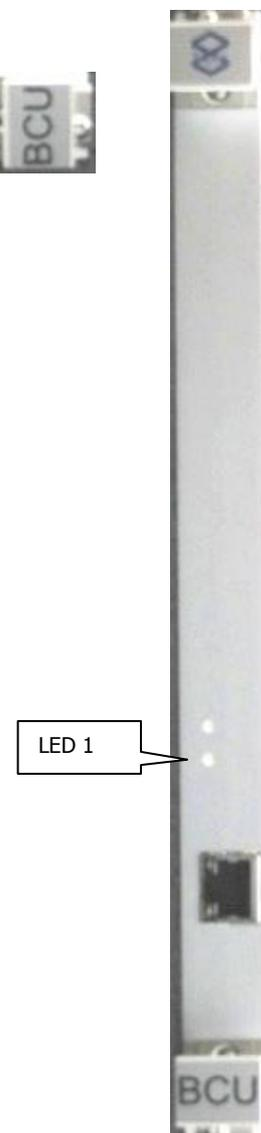
**Abbildung 19: BCU (aufrechte Lage beim Einbau in 6HE Chassis)**
