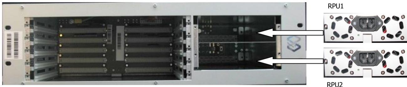
**Abbildung 5: S6+ bestückbar mit ein oder zwei redundanzfähigen Netzteilen (1F5009S)**
