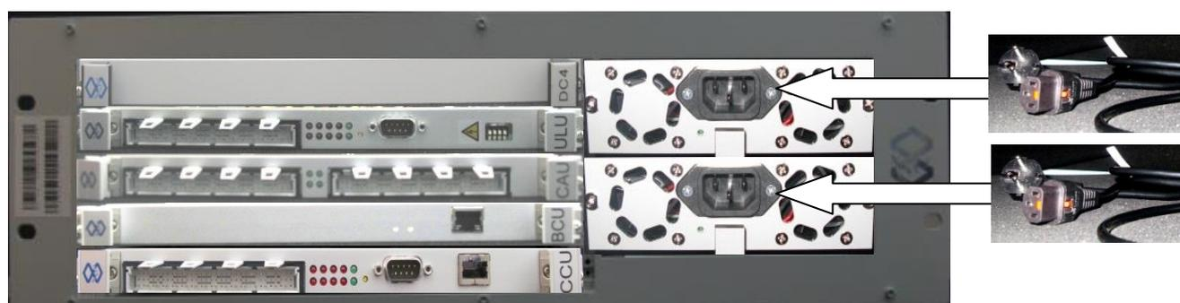
**Abbildung 6: S6+ bestückt mit redundanzfähigen Netzteilen sowie CCU3, BCU, CAU, ULU und DC4**
